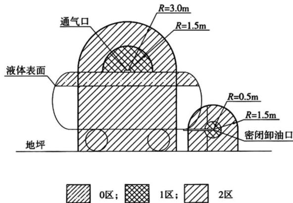
图2 汽油油罐车的爆炸危险区域
