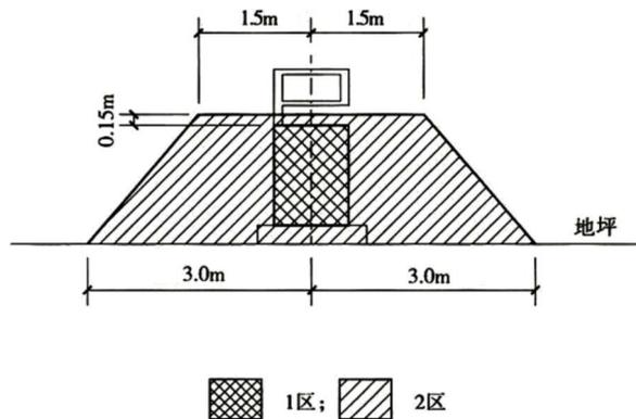
图3 汽油加油机的爆炸危险区域
