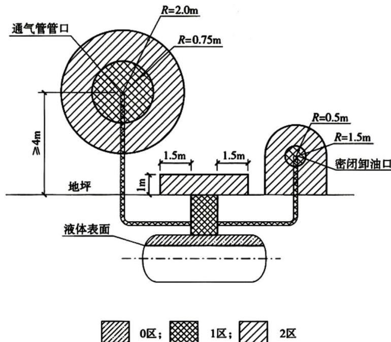
图 1 汽油埋地卧式油罐的爆炸危险区域
