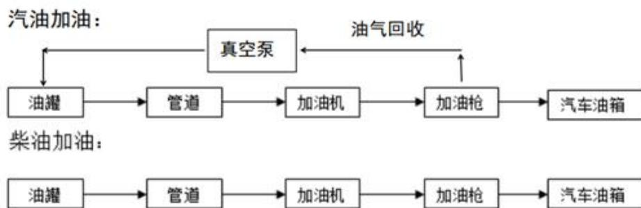
图 2.5-2 加油工艺流程图
