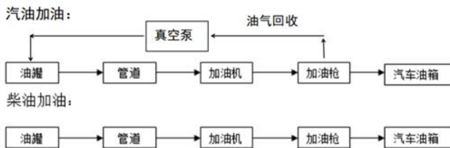
图 2.5-2 加油工艺流程图
