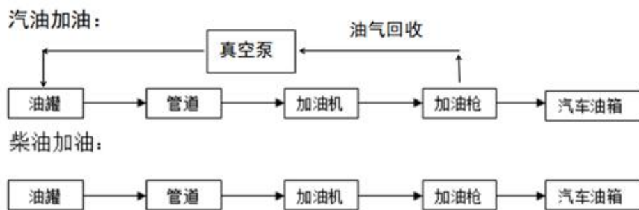
图 2.5-2 加油工艺流程图
